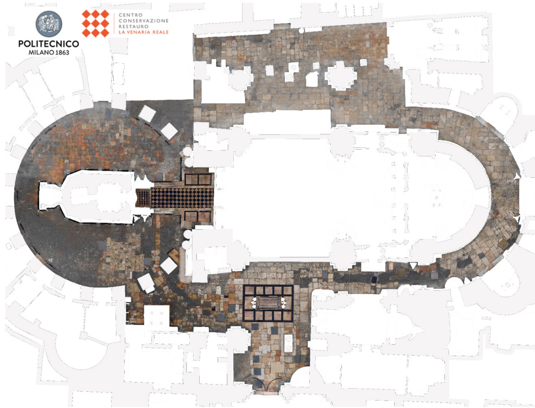
Figura 2. Il pavimento lapideo della Basilica del Santo Sepolcro prima dell'intervento di Restauro (Settembre 2021, risoluzione di acquisizione di un pixel (GSD) pari a 0.2mm) – Politecnico di Milano
