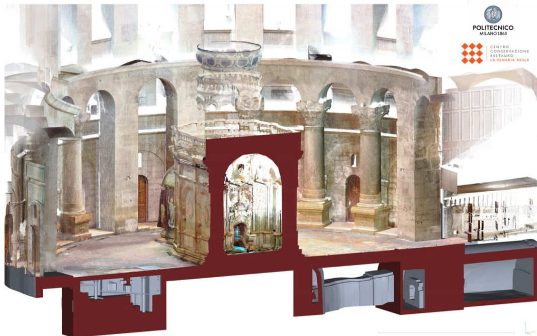
Figura 1: vista tridimensionale del modello HBIM del pavimento e del dato laser scanner nell'area della Rotonda dell'Anastasi della Basilica del Santo Sepolcro. Il lavoro di restauro deve tenere conto della complessa architettura dell'edificio, fatta anche di ambienti e stratificazioni sotterranee - Politecnico di Milano
